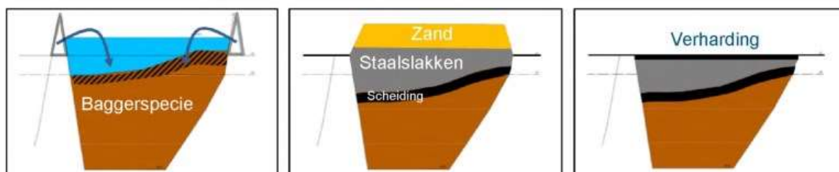
Figuur 3-1: Verwerking specie en staalslakken in variant B1 (schets, niet op schaal)
