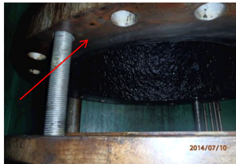
Foto 6 Hier is de pakking verwijderd
