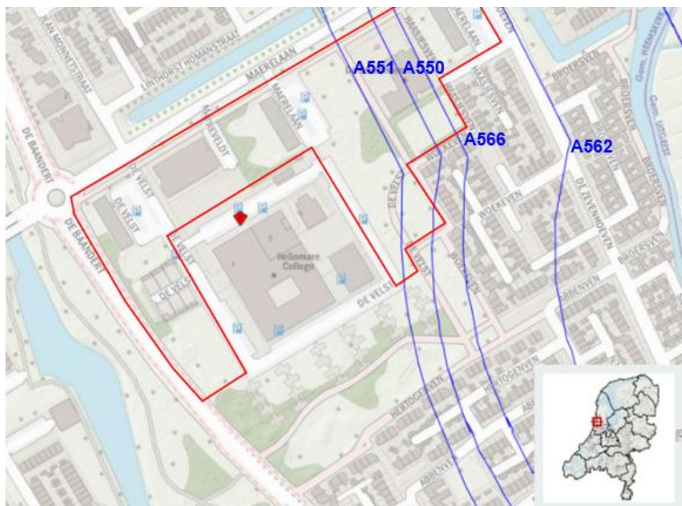
Afbeelding 7 aanwezige veiligheidszone vanwege gasleidingen in het plangebied
