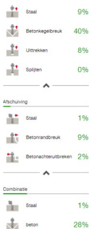
Figuur 7-3: Berekeningsresultaten kolomvoetplaatverbinding staander-fundering
