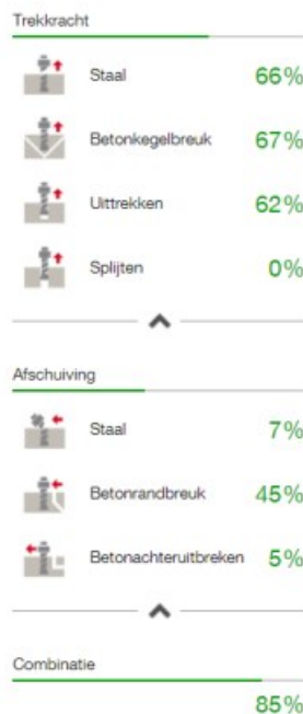
Figuur 9-3: Berekeningsresultaten kolomvoetplaatverbinding staander-fundering
