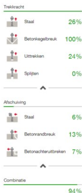
Figuur 8-3: Berekeningsresultaten kolomvoetplaatverbinding staander-fundering
