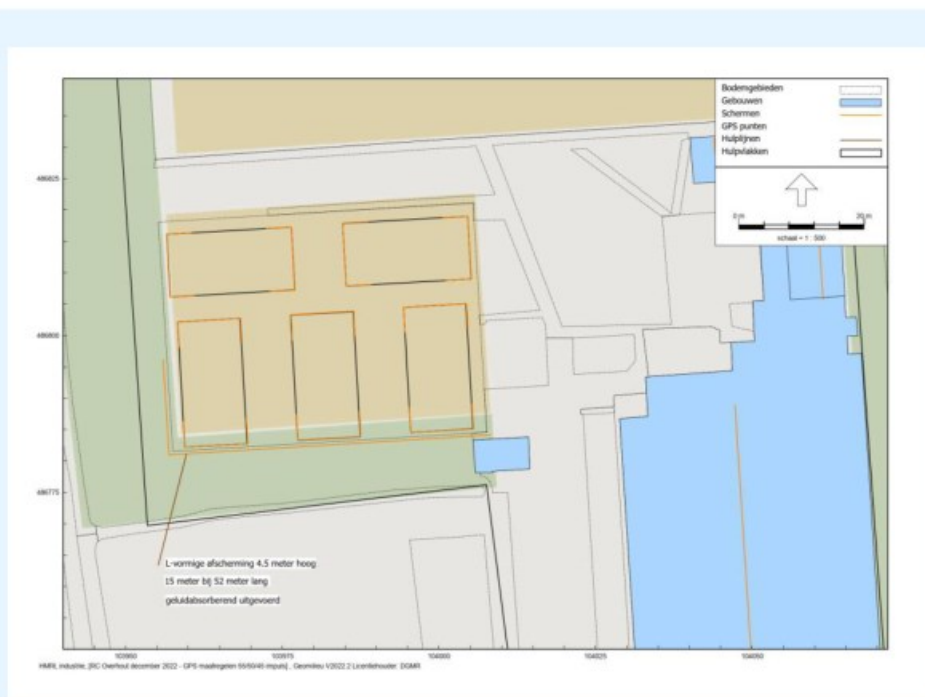
figuur 5: weergave ligging afschermingen volgens maatregelenvariant 2
