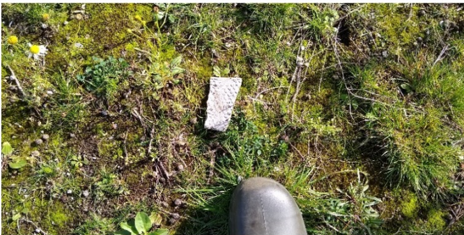
Foto 36 Asbestverdacht materiaal
