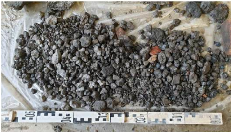
Figuur 4.1 Foto gespoelde fractie < 25 mm van staalslak vermengd met baggerspecie [20]
