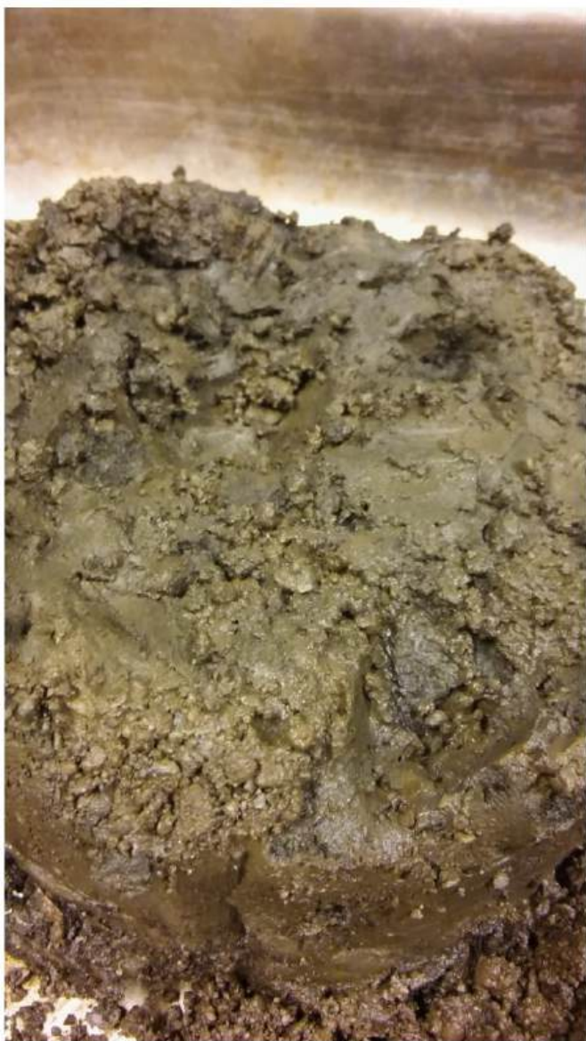
Figuur 3.3 Detail van het oneffen sliboppervlak nadat aan het einde van de test de staalslakken zijn verwijderd..
