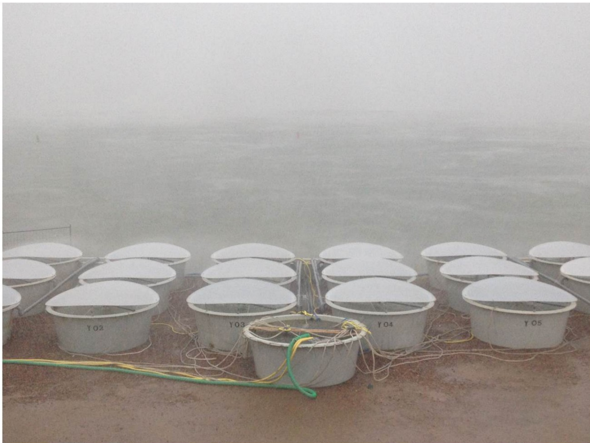
Figuur 2 De mesocosms waren afgedekt met polycarbonaat platen om de invloed van regen op de waterkwaliteit te beperken.
