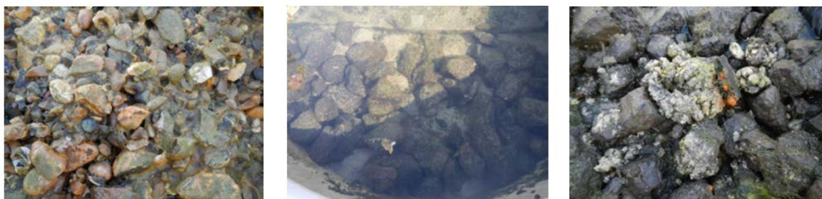
Figuur 5 Van links naar rechts: grind, breuksteen en staalslakken bij de eindbemonstering van de mesocosms na 12 weken blootstelling.
